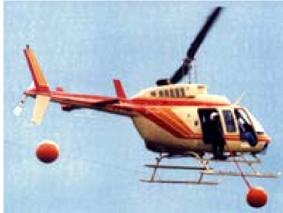
FIGURA 2 – Instalação com helicóptero (1)
